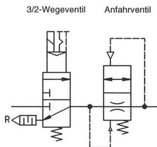
Belüftung der Anlage über Drosselstellung des Anfahrventils.
